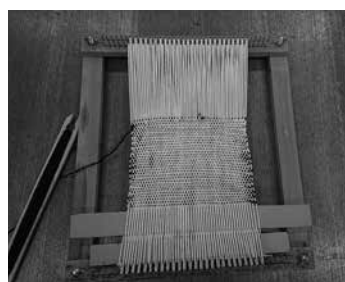
四隅をボルトにし、作りたい丈の長さに応じて枠の長さを調節できるようにした2代目の木枠 (50 × 45cm)
